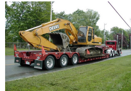
מחפר רתום בשיטת ריתום ישיר בעזרת שרשראות ריתום וחוסום על ידי החלק המוגבה של המרכב
