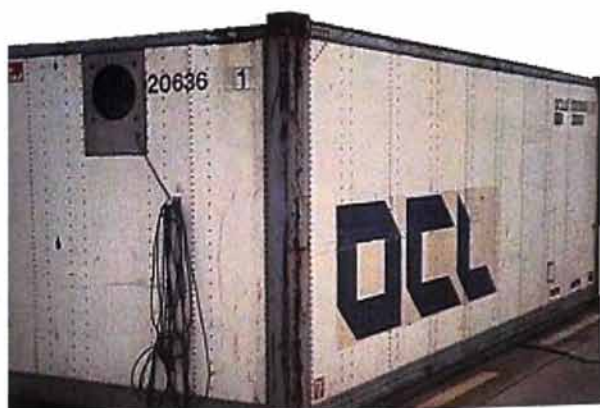
מכולה רגילה בעלת התקן אוורור מכני המותקן בדופן הקידמית
