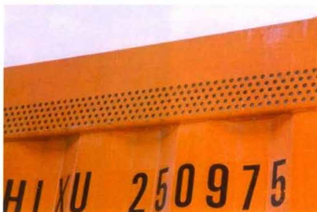
מבט מקרוב על רשת האוורור הסמוכה לקורת האורך העליונה של מכולה רגילה.
