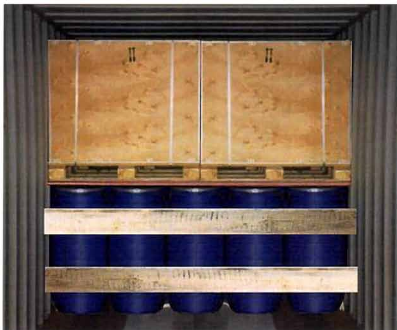
עיגון קורות עץ רוחביות בשקעי דפנות הצד הגליות המחוזקות מצד לצד
