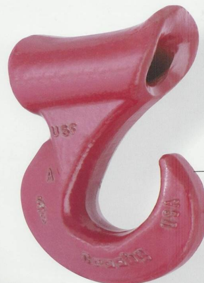
אונקל החלקה לכבל דגם A-350 קטרים: 10 מ"מ עד 36 מ"מ שימושים: חיבור למענבי כבל לביצוע חניקה
