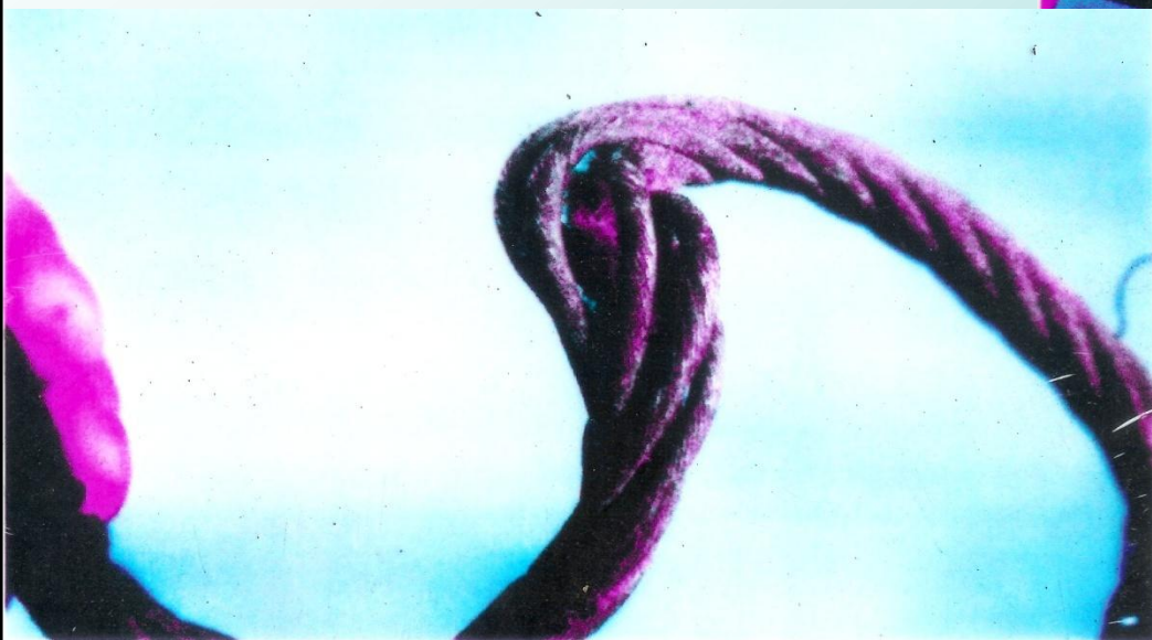
Искривление кабеля и сердцевина открыта
