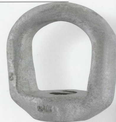
בורג עין סובב LBG קטרים: 8 מ"מ עד 36 מ"מ (ניתן לקבל גם במידות אינצ'יות) שימושים: הרמות ישירות וצידיית, עיגונים ישירים וצידיים
